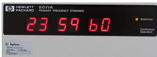
*Přestupná sekunda viditelná na displeji automaticky řízených hodin. Foto: Karel Halíř.*
