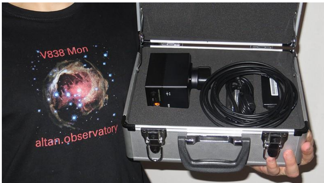
Obrázek 7: Nová CCD kamera G2-0402 s interním filtrovým karuselem a hliníkovým kufrem
